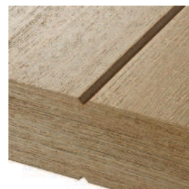
detail frézovania - viditeľná štruktúra prírodného dubu
